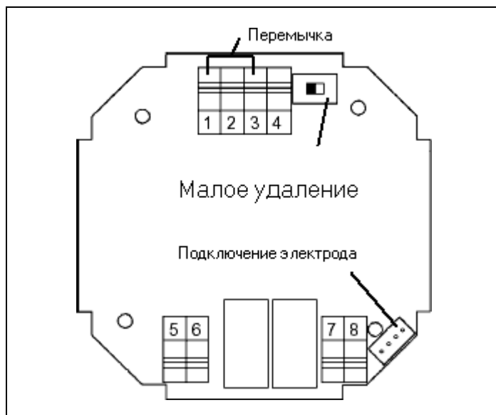
Рис. 3.9 Трансмиситтер 8225 с 2 реле
